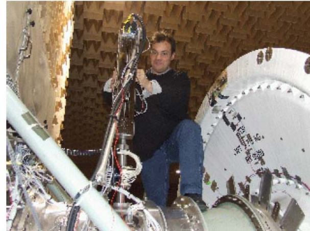
(b) Fan-OGV gap hot wire probe
